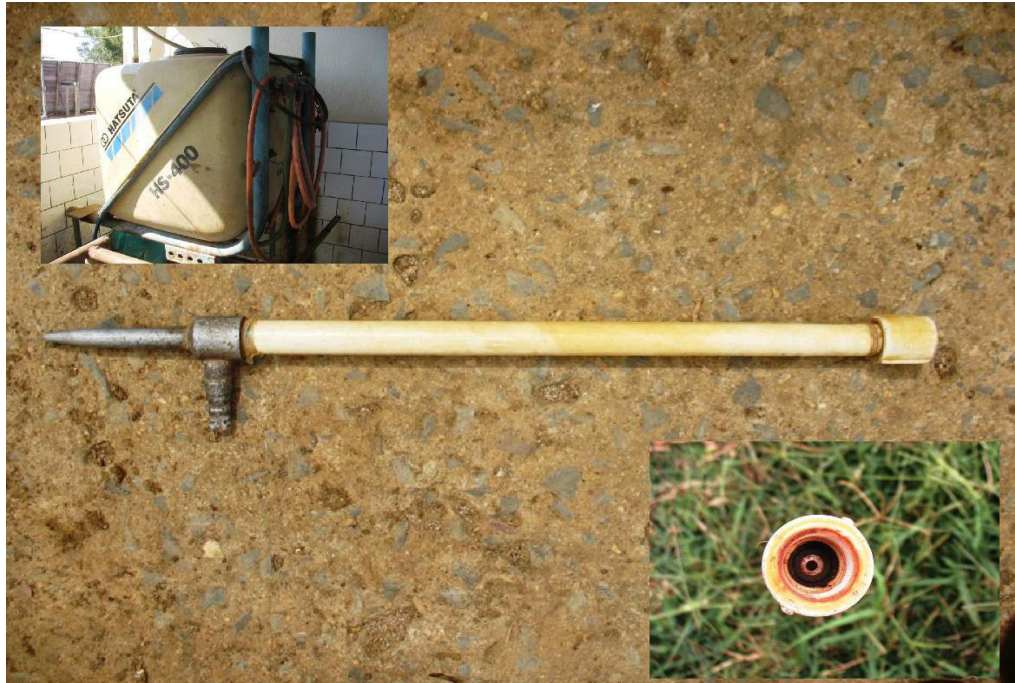
Figura 2. Equipamento utilizado para técnica Usual: barra de aspersão improvisada e em detalhe, o bico de aspersão e o reservatório.
